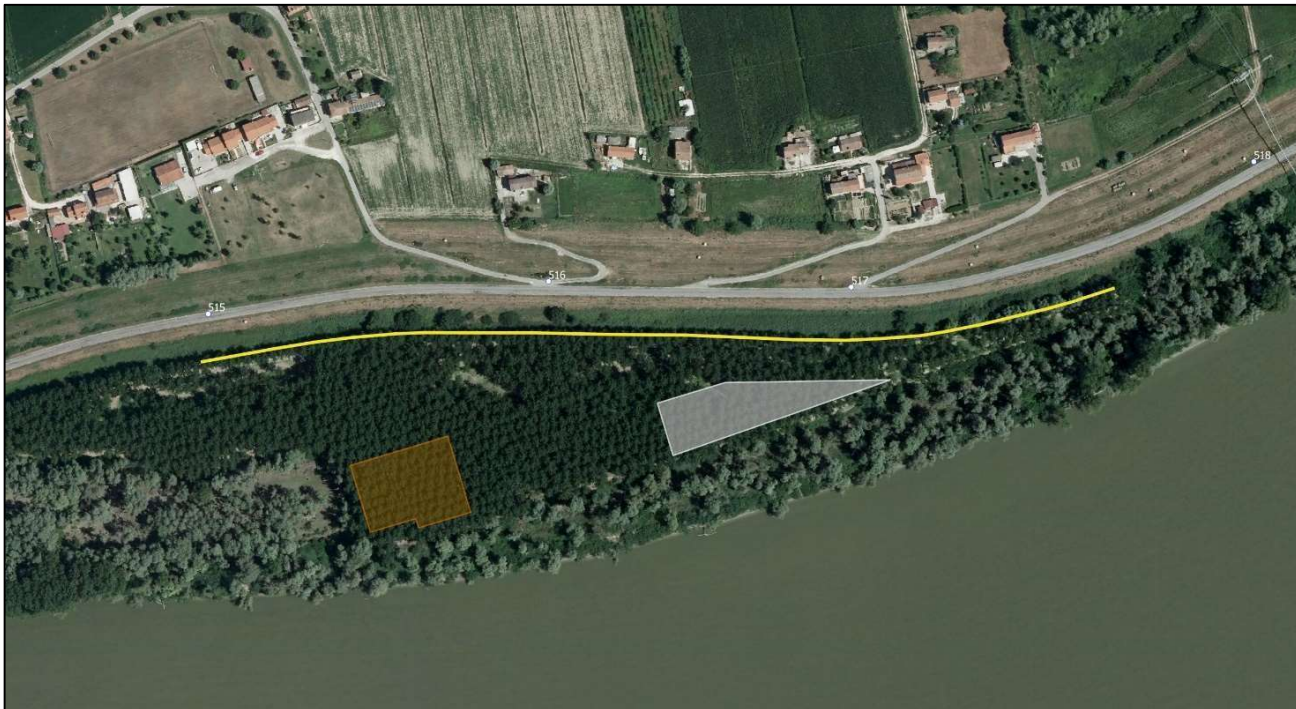
Figura 2 - Inquadramento generale dell'area interessata dall'intervento in località Mazzorno Sinistro nel comune di Adria (RO); la linea gialla evidenzia il diaframma di progetto, il poligono marrone a sinistra l'area golenale di prelievo della terra (1° stralcio), il poligono grigio a destra l'area di deposito temporaneo del pietrame.
