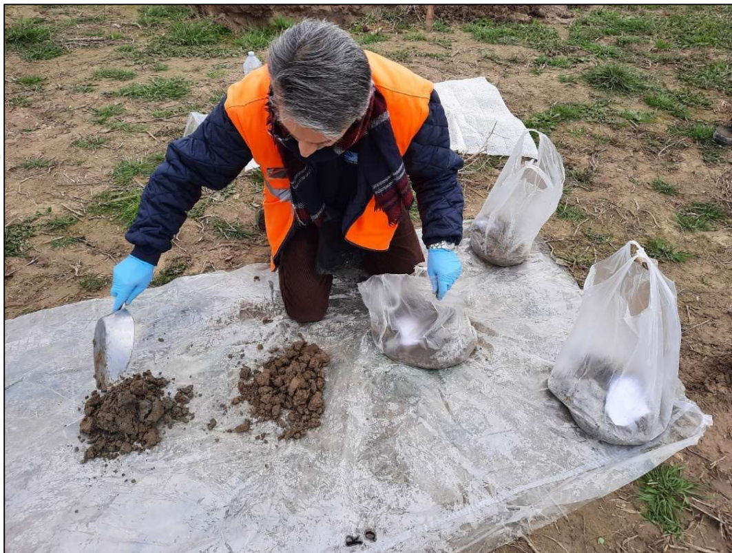
Figura 13 – Operazioni di miscelazione e omogeneizzazione del campione composito di terreno in area golenale.
