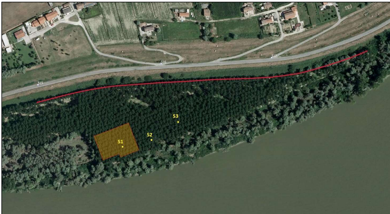
Figura 12 - Localizzazione scavi esplorativi effettuati con mini-escavatore in area golenale eseguiti ai fini della caratterizzazione ambientale ai sensi della normativa “terre e rocce da scavo” - loc.tà Mazzorno Sinistro – Adria (RO). Il poligono marrone individua l’area di prelievo della terra golenale (1° stralcio).
