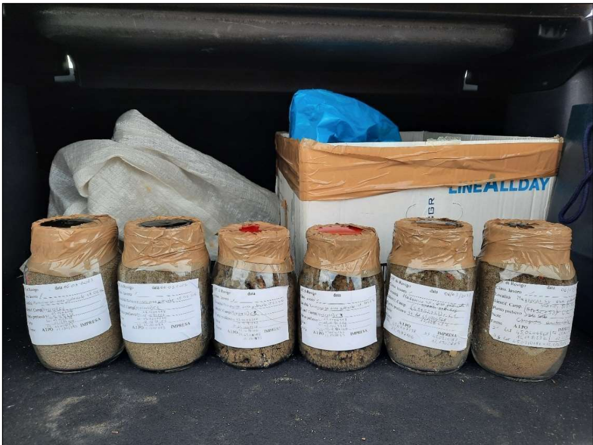
Figura 14 – Campioni compositi di terreno golenale riposti in contenitori in vetro sigillati.
